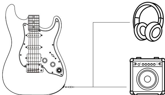
**Step 2:** GTRSコントロールノブを時計回りに回し、ギターの電源を入れます。ノブLEDが点灯してON/OFFを表示します。
